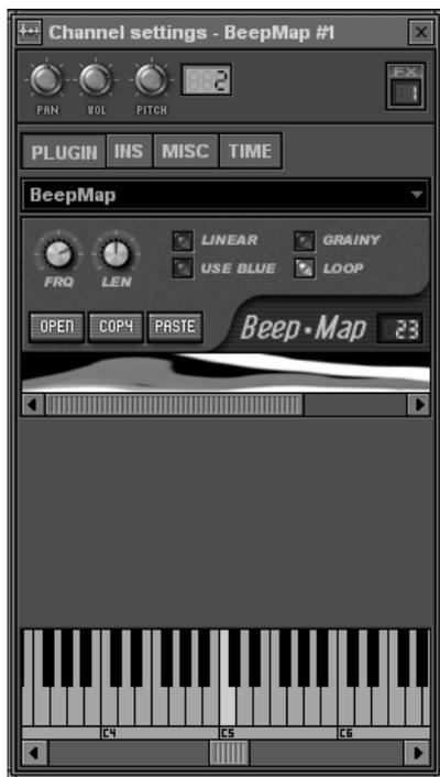
**Рис. 6.31.** Вкладка **PLUGIN** диалогового окна **Channel settings** в случае инструмента ВеерМар
