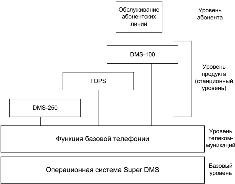
Рис. 9.12. Архитектура программного обеспечения DMS-100
