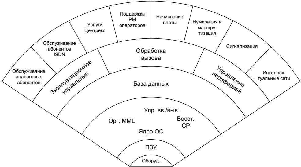
Рис. 9.10. Структура программного обеспечения EWSD
