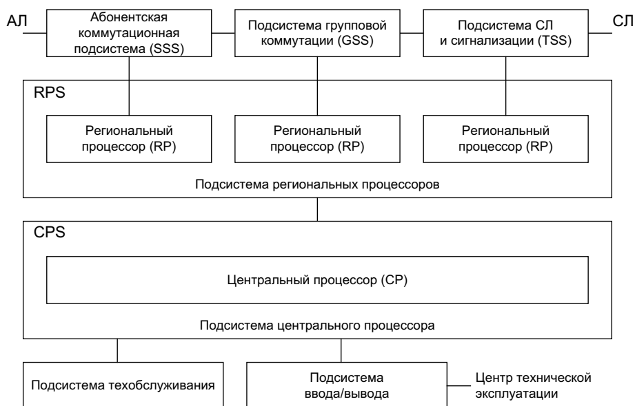
Рис. 5.13. Архитектура аппаратных средств АРТ станции AXE 10
