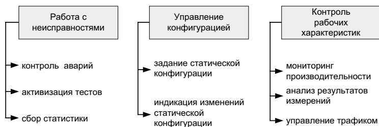
Рис. 10.8. Функции эксплуатационного управления ОКС7
