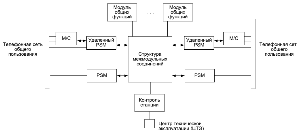
Рис. 5.15. Архитектура Linea UT4
