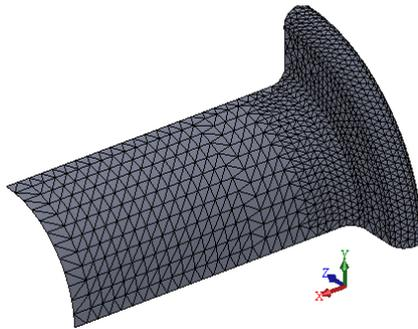
Рис. 1.61. Сетка конечных элементов оболочечной модели
