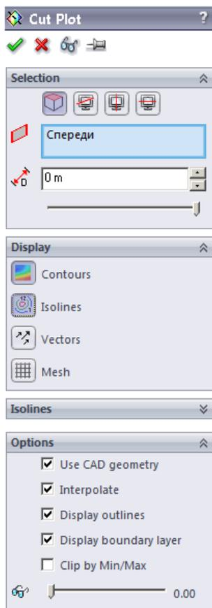
Рис. 2.40. Настройка отображения пограничного слоя
