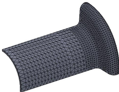
Рис. 1.50. Сетка твердотельных конечных элементов
