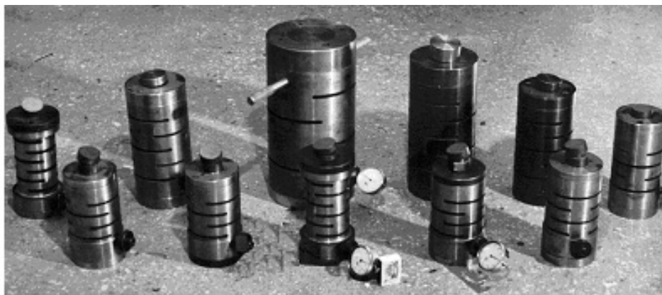
Рис. 4.2.7. Динамометры переносные образцовые упругие 3-го разряда с предельным нагружением от 100 до 10 000 кН
