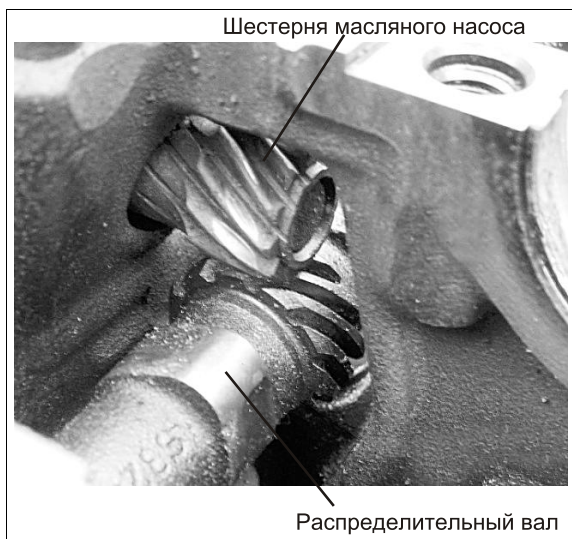
Рис. 2.17. Шестерня со спиральным зубом
