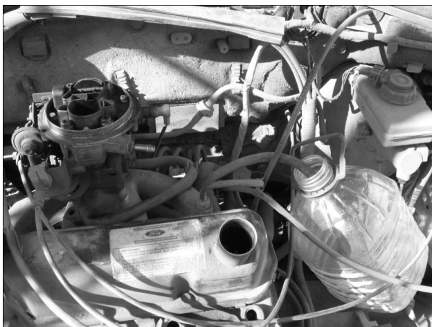
Рис. 2.51. Подача топлива в карбюратор
