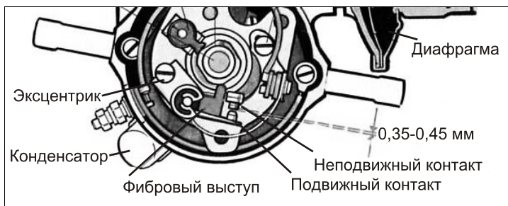
Рис. 3.7. Регулировка зазора между подвижным и неподвижным контактами
