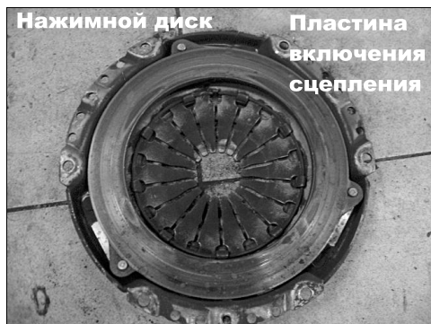
Рис. 4.4а. Устройство сцепления. Вид со стороны нажимного диска
