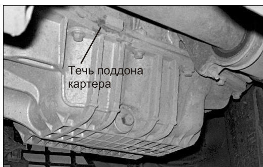
Рис. 2.59. Течь прокладки поддона картера
