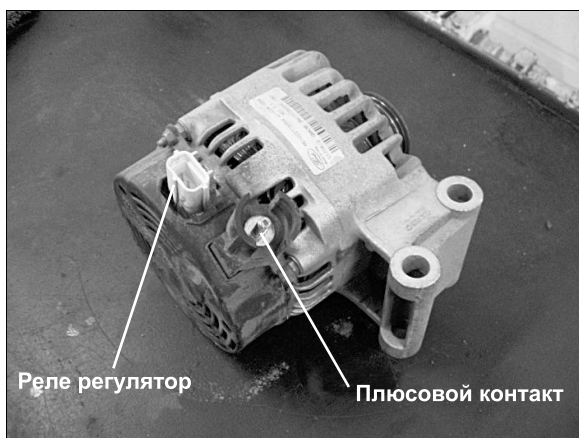
Рис. 3.4а. Вид генератора со стороны электрических разъемов
