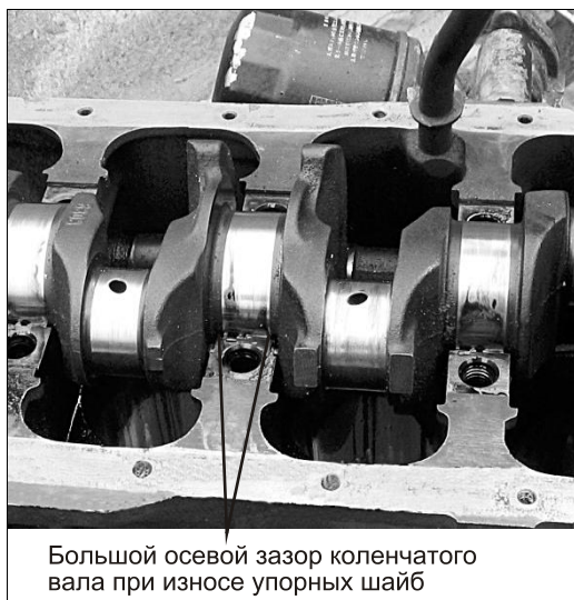
Рис. 2.49. Зазор коленчатого вала при износе упорных шайб
