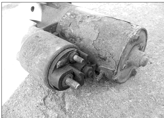
Рис. 3.6. Плюсовой провод стартера
