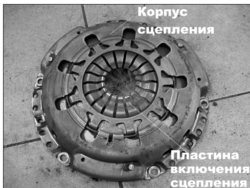
Рис. 4.46. Устройство сцепления. Вид со стороны пластины включения сцепления
