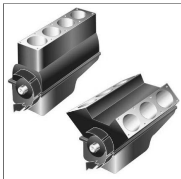
Рис. 2.13. Направление вращения двигателя
