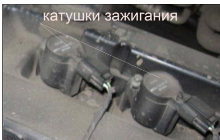
Рис. 3.3. Катушка зажигания, совмещенная со свечным наконечником
