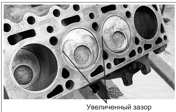
Рис. 2.45. Зазор между поршнями и стенками цилиндров
