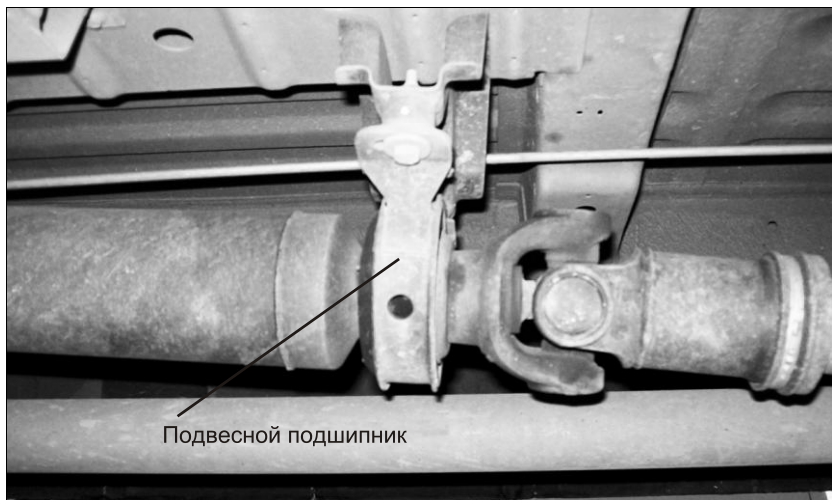
Рис. 1.3. Длинный карданный вал с подвесным подшипником
