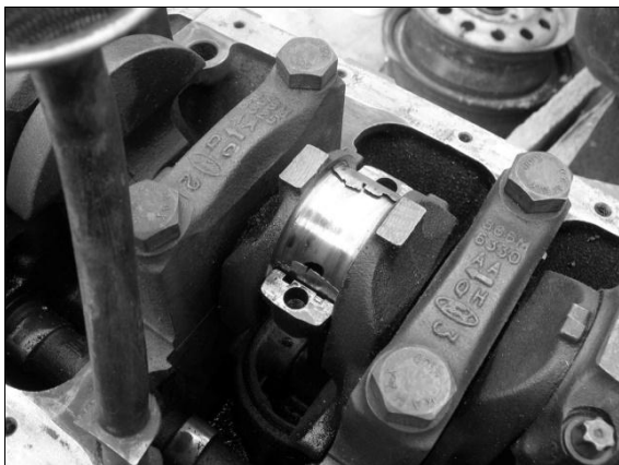
Рис. 2.44. Зазоры в подшипниках
