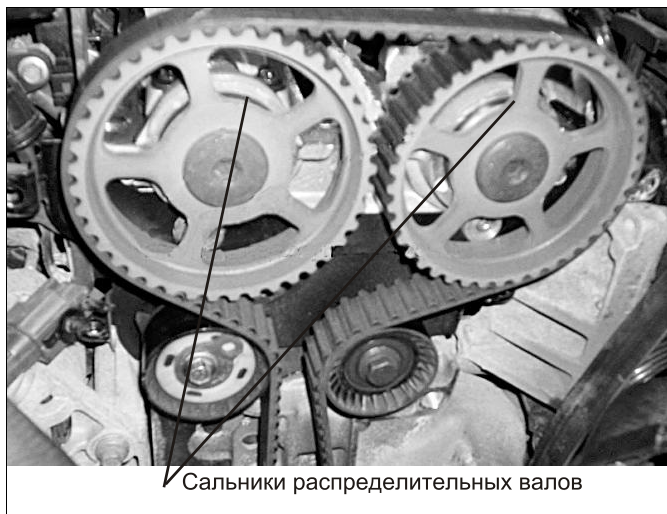
Рис. 2.64. Течь сальников распределительных валов
