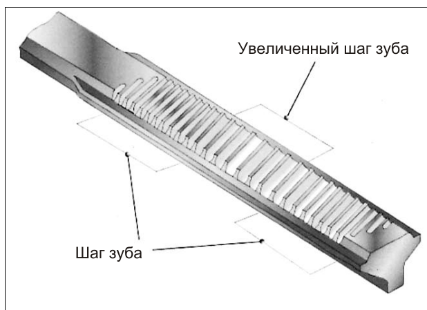
Рис. 5.34. Рейка рулевого механизма с переменным шагом зубьев
