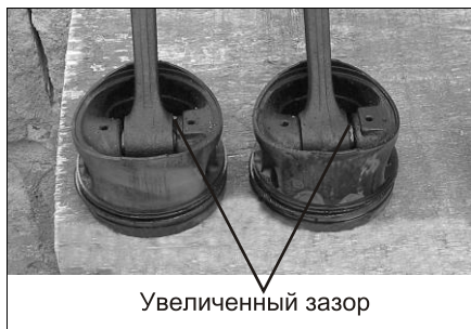
Рис. 2.47. Зазор во втулках верхних головок шатунов
