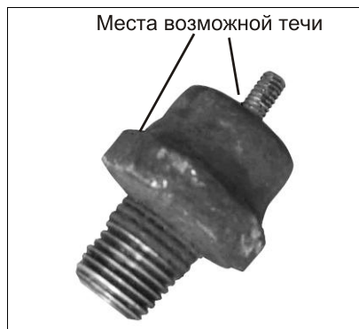
Рис. 2.63. Течь датчика давления
