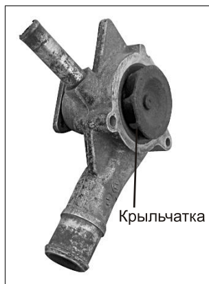
Рис. 2.21б. Крыльчатка водяного насоса
