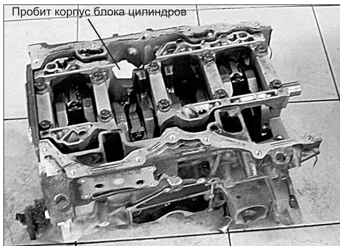
Рис. 2.58. Разрушение блока цилиндров
