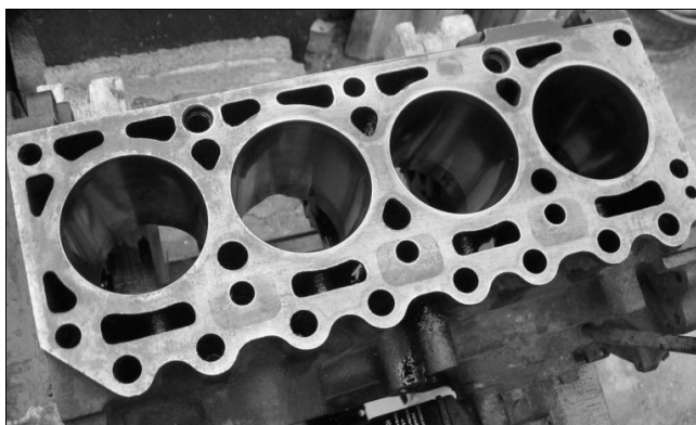
Рис. 2.19б. Двойные стенки цилиндров
