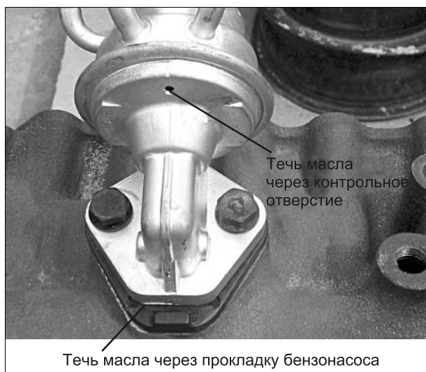
Рис. 2.65. Течь прокладки бензонасоса
