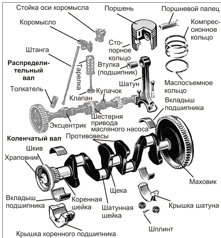
Рис. 2.14. Устройство кривошипно-шатунного и газораспределительного механизмов
