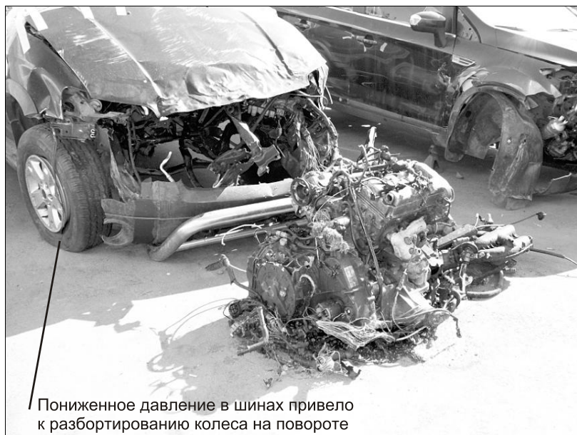
Рис. 1.5. Результат невнимательности при осмотре шин
