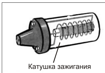
Рис. 3.1. Катушка зажигания ранних моделей автомобилей
