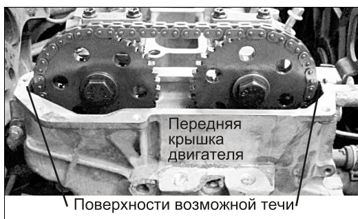
Рис. 2.61. Течь прокладки клапанной крышки
