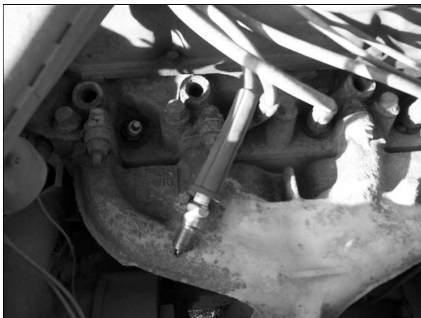
Рис. 2.55. Поиск цилиндра, работающего с перебоями
