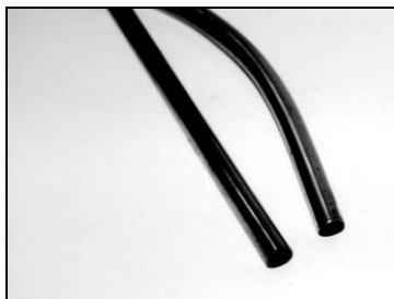
Рис. 3.8. Труба из жесткой меди и гибкая труба из мягкой меди. Обратите внимание на небольшой изгиб гибкой трубы после того, как она была свернута в бухту
