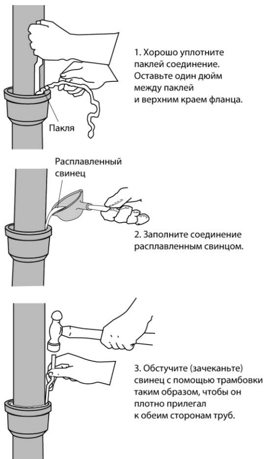
Рис. 5.35. Герметизация соединений вертикальных чугунных труб
