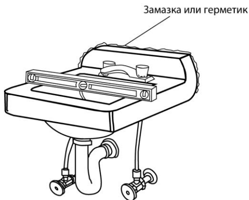
Рис. 7.14. Раковину необходимо выровнять и загерметизировать место ее соприкосновения со стеной
