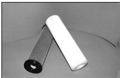
Рис. 7.54. Существуют два типа фильтрующих элементов для картриджа. Изображенный слева фильтр из активированного угля уменьшает вкус и запах хлора, а также удаляет осадок. Осадочный фильтр справа удаляет песок, отложения и частицы ржавчины в воде
