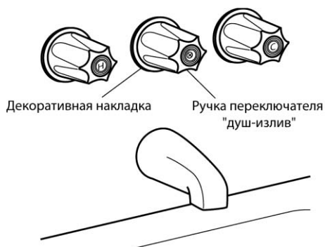
Рис. 6.18. Смеситель типа "ванна-душ" с тремя ручками. С помощью ручки переключателя посередине осуществляется переключение воды в душевой шланг
