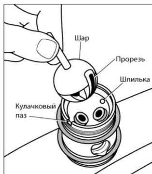
Рис. 6.15, б—е. Ремонт смесителя шарового типа: отвинтите крепежный винт и снимите ручку (б); с помощью обмотанных изолентой клещей отвинтите стопорную кольцевую гайку (в); снимите и замените изношенные пружины и прокладки (г); замените кольцевые уплотнительные прокладки на корпусе вентиля (д); соберите смеситель (е)
