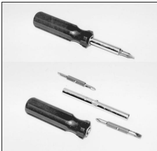
Рис. 4.2. Универсальные отвертки имеют различное применение. В верхней части рисунка отвертка в собранном виде. В нижней части — большая и маленькая плоская и крестовая головки
