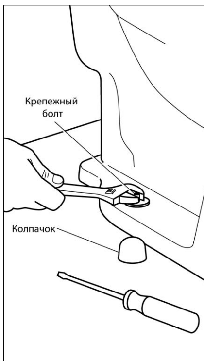
Рис. 6.48. Перед тем как снять унитаз, снимите колпачки с крепежных болтов и отвинтите гайки
