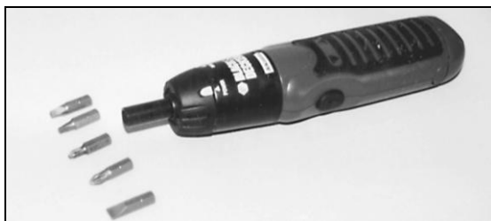
Рис. 4.10. Электрический шуруповерт с различными насадками имеет многоцелевое применение
