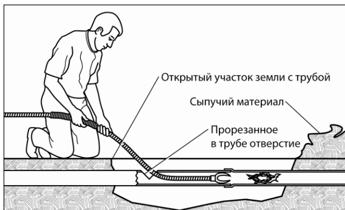
Рис. 6.33. Прodelайте отверстие в сливной или канализационной трубе для устранения засора. Трубу можно будет заделать с помощью пластика, войлока или металла и заново засыпать
