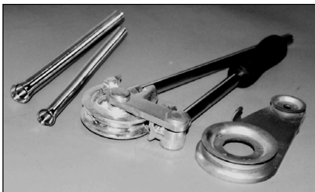
Рис. 4.20. Гибочные инструменты для гибких медных труб включают в себя гибочные пружины, трубогибы для гибких труб и труб для электропроводки и гибочные приспособления для труб малого диаметра
