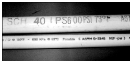
Рис. 3.10. Трубы из ПВХ (вверху) и ХПВХ (внизу). На обеих нанесена маркировка ограничения по температуре и давлению
