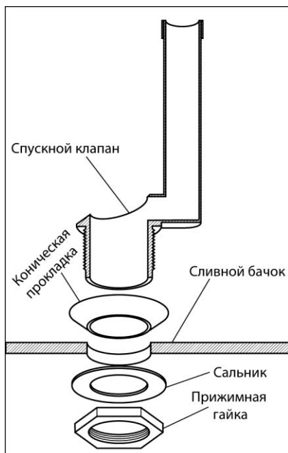
Рис. 6.47. Соединение спускного клапана и сливного бачка включает конусную прокладку, сальник и прижимную гайку
