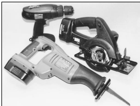
Рис. 4.9. Беспроводные электроинструменты очень удобны. Здесь изображены дрель, дисковая пила и электропила с узким лезвием (сабельная пила), часто используемые в сантехнических работах
