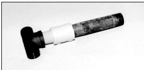
Рис. 2.6. Пластиковый переходник между медной и стальными трубами предотвратит возникновение пробки в результате электролитической реакции
