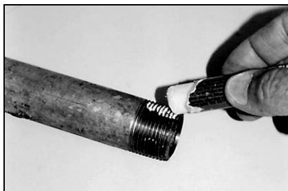
Рис. 5.30. Применяйте герметик в виде пасты или карандаша. Нанесите его по всей окружности резьбы
