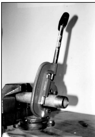
Рис. 5.23. Режьте оцинкованные трубы с помощью трубореза
