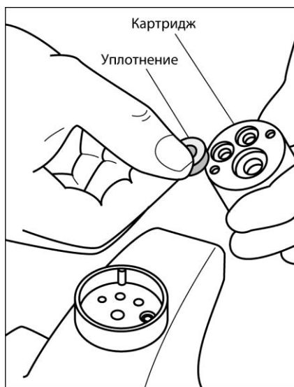
Рис. 6.16, а—в. Ремонт картриджного смесителя дискового типа: открутите винты и выньте картридж (а); уберите старые уплотнения и очистите диск картриджа (б); вставьте новые уплотнения и заново соберите смеситель (в)
