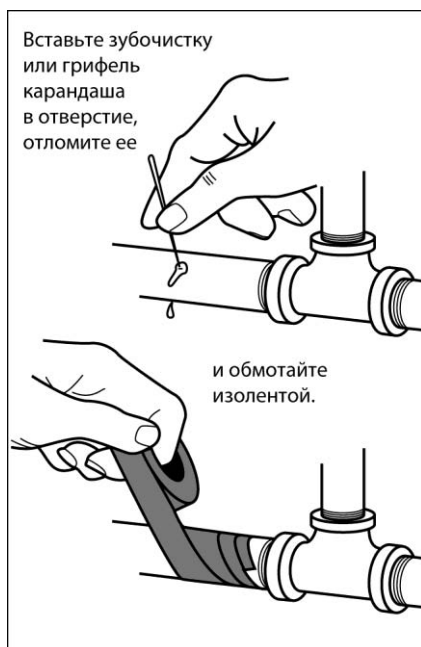
Рис. 6.61. С помощью зубочистки заткните небольшое отверстие. Затем намотайте вокруг него изоленту и скрепите зажимом, как это показано на рис. 6.59
