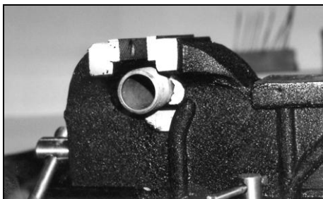
Рис. 5.5. У хороших верстачных тисков под обычными плоскими губками имеются губки для захвата труб
