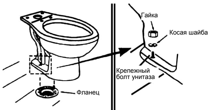
Рис. 6.53. Установите унитаз на фланец (American Standard)
