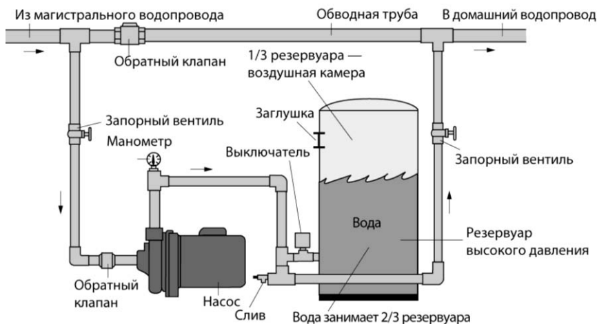
Рис. 3.30. Подкачивающий насос помогает поддерживать более высокое давление воды
