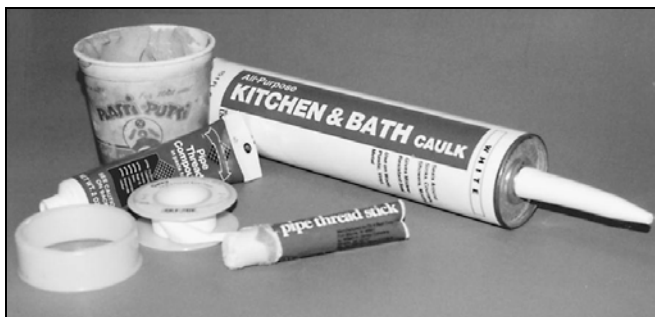
Рис. 4.24. Уплотнительный материал или герметики, используемые для выполнения сантехнических работ, включают: тефлоновую ленту, уплотнительную замазку для резьбы в виде карандаша, уплотнительную пасту для резьбы в трубе, мастику для труб и силиконовый герметик для ванной комнаты
