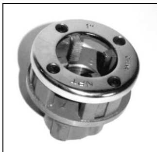
Рис. 5.26. Для нарезания резьбы на оцинкованной трубе выберите сначала плашку необходимого размера. Размер выбит на рабочей поверхности плашки
