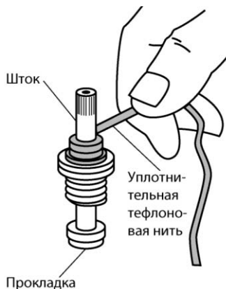
Рис. 6.11. Протечку в ручке крана можно устранить с помощью нового уплотнительного сальника или уплотнительной тефлоновой нити
