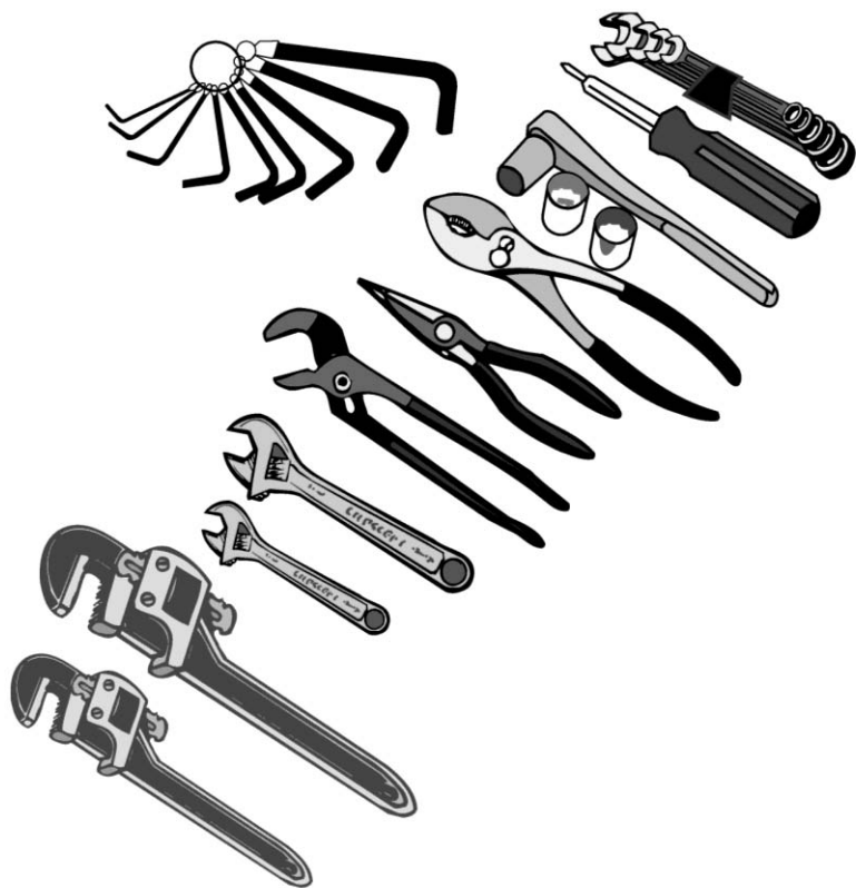
Рис. 4.1. Распространенные захватные инструменты и инструменты для проворачивания. Наверху слева — набор имбусовых ключей (шестигранных ключей). Начиная сверху расположены: набор комбинированных гаечных ключей, универсальная отвертка с большой и маленькой плоской и крестовой головками, комплект торцевых ключей с трещоткой, простые плоскогубцы, острогубцы и переставные клещи. Также необходимы разводные и трубные ключи разных размеров
