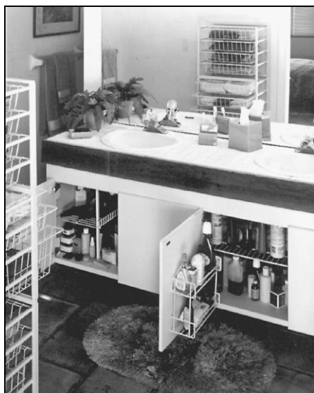
Рис. 7.19. Два типа встроенных раковин: встроенные в столы с местом для хранения (а); уложенные на столешницу с открытым местом под раковиной (б)
