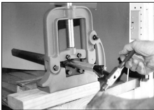
Рис. 5.9. Большая трубная развертка для снятия заусенцев применяется для труб большого диаметра. Для обработки внешней поверхности используется напильник
