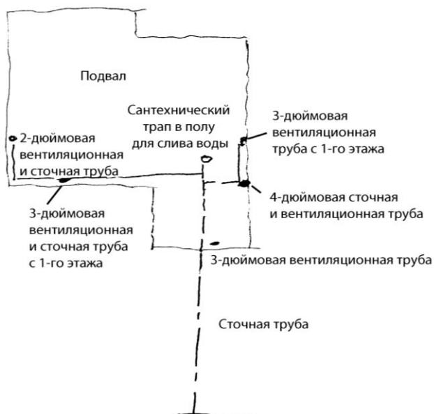
Рис. 3.3. Схема сточной (канализационной) и вентиляционной системы
