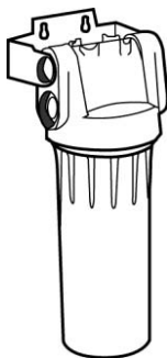
Рис. 7.56. Фильтры под мойку крепятся с помощью монтажного кронштейна
