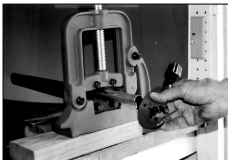
Рис. 5.4. Используйте развертку на трубобрезе для удаления заусенцев на срезе трубы
