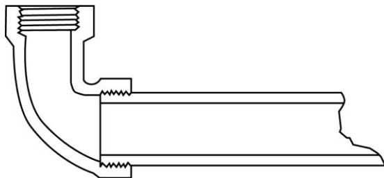
Рис. 5.22. Оцинкованные трубы следует резать с учетом допусков на резьбу для каждого фитинга. Рекомендуется оставлять минимальный допуск из расчета четыре-пять витков резьбы
