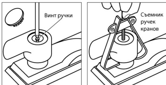
Рис. 6.3. Снимите ручки кранов. Неподдающиеся ручки кранов снимайте с помощью съемника
