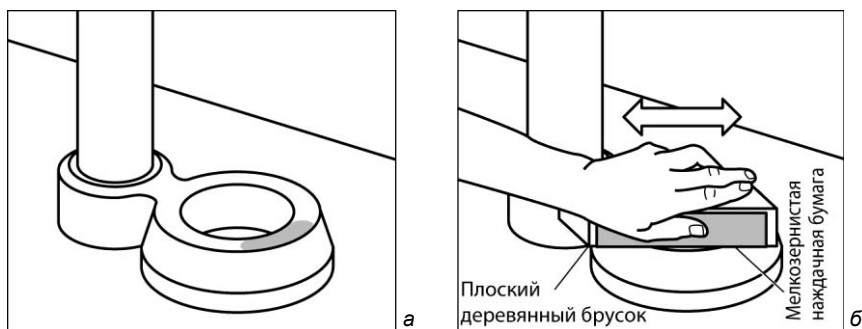
Рис. 6.43. Обновите поверхность седла спускного клапана с помощью наждачной бумаги
