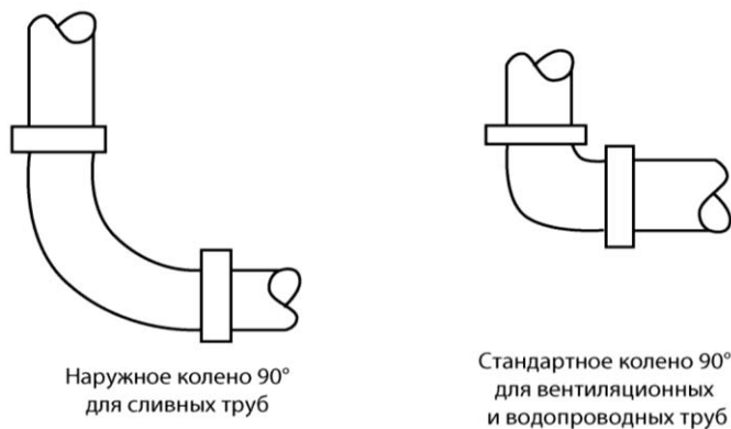
Рис. 3.14. Сливной фитинг имеет более длинный и закругленный изгиб
