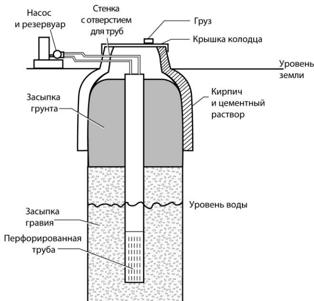
Рис. 8.5. Готовый колодец с крышкой и заполнением
