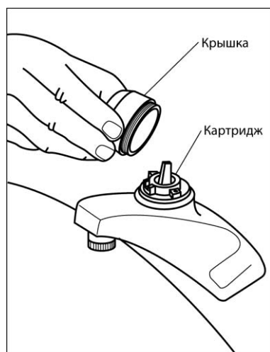
Рис. 6.16, а—в. Ремонт картриджного смесителя дискового типа: компоненты смесителя (а); поднимите ручку, ослабьте крепежный винт и снимите ручку (б); снимите крышку (в)
