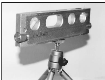
Рис. 4.16. С помощью небольшого лазерного уровня можно задать горизонтальную линию, вертикальную линию и точку. Установив лазерный уровень на штатив, можно задать необходимый уровень или угол наклона
