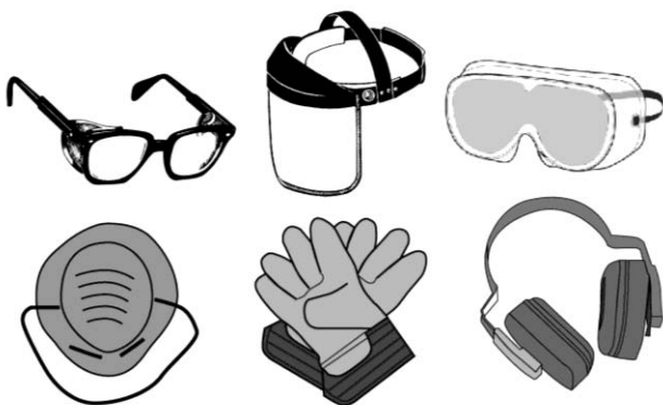
Рис. 4.12. Обязательным является применение защитных средств: различных очков и щитков для защиты глаз, фильтрующих масок, перчаток и звукозащитных наушников
