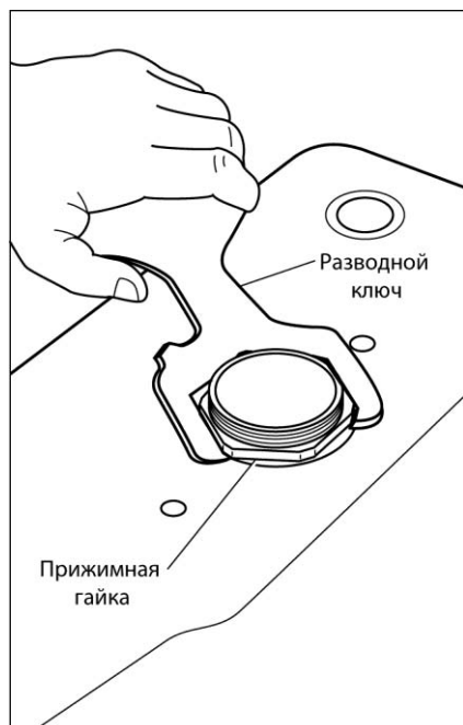
Рис. 6.46. Воспользуйтесь разводным ключом, чтобы отвинтить прижимную гайку внизу бачка
