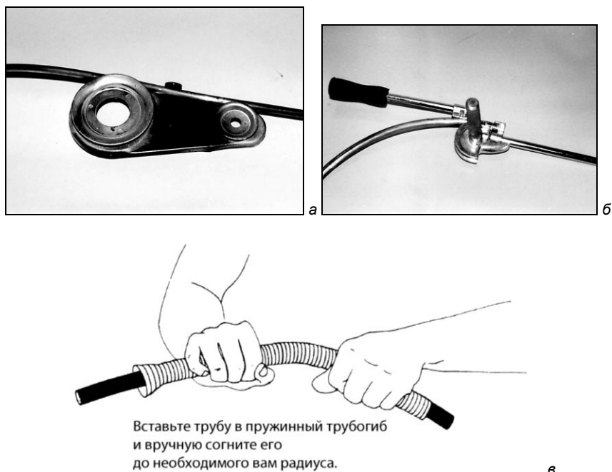
Рис. 5.11. Способы гибки мягких медных труб: гибка с помощью трубогиба для гибких труб (а); рычажного трубогиба (б); пружинного трубогиба (в)
