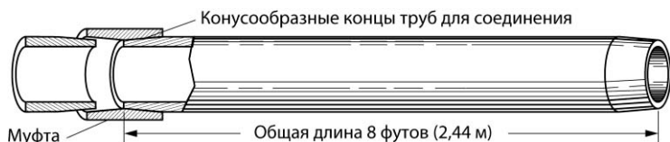
Рис. 5.38. Соединение стекловолоконных труб
