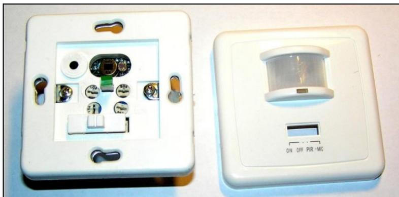
**Рис. 3.67.** Вид датчика LX-2000 со снятой передней панелью — для доступа к элементам настройки
