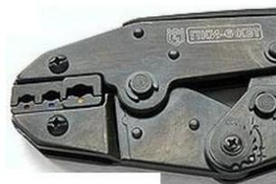
**Рис. 3.84.** Инструмент для обжима клемм и контактов
