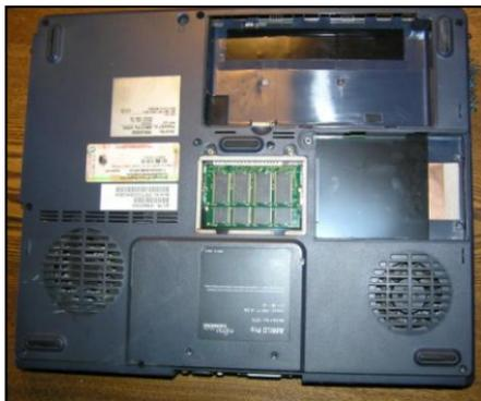
Рис. П3.2. Вид на ноутбук снизу с вынутыми АКБ и жестким диском
