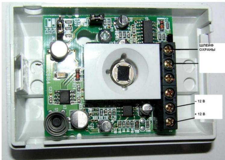
**Рис. 3.61.** Вид датчика "Фотон-9" со снятой крышкой
