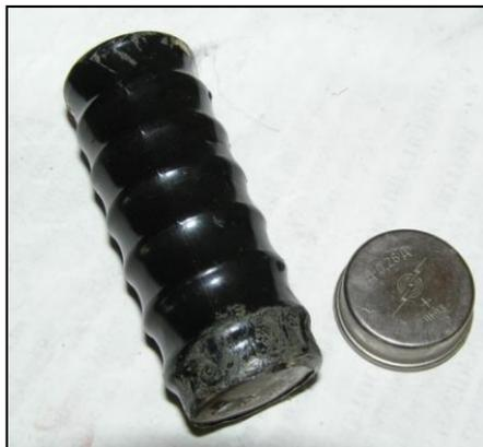
**Рис. ПЗ.7.** Внешний вид линейки аккумуляторов, соединенных в батарею.
