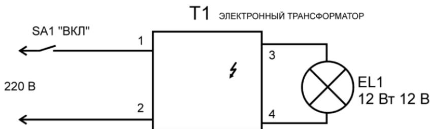
Рис. 3.95. Электрическая схема подключения электронного трансформатора
