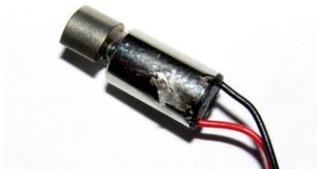
**Рис. 3.99.** Вид на портативный электродвигатель из машинки для выщипывания волос
