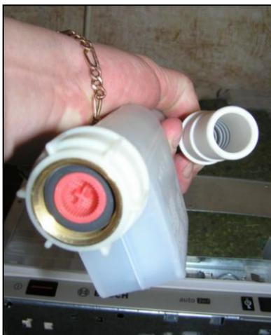
**Рис. 1.31.** Вид на встроенный фильтр в электромагнитном клапане
