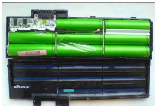
Рис. ПЗ.5. Вид на снятую крышку корпуса АКБ ноутбука SQV-403
