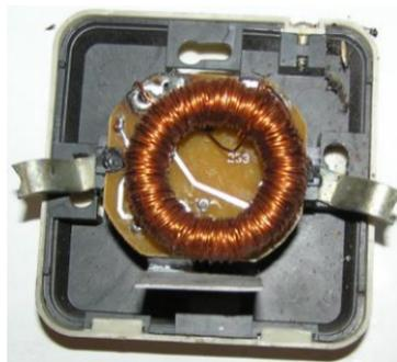
**Рис. 3.93.** Вид на диммер и элементы крепления со снятой крышкой его корпуса
