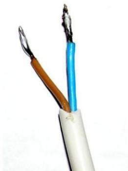
**Рис. 3.11.** Опасные концы электрических проводов перед подключением
