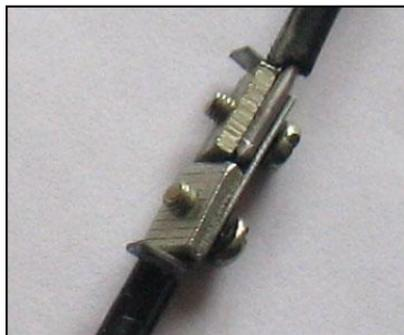
**Рис. 3.27.** Крепление с помощью металлических пластин
