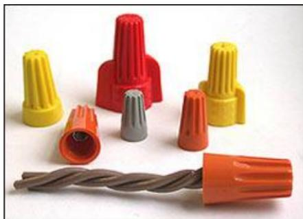
**Рис. 3.33.** Винтовое соединение проводов с помощью изолирующих колпачков
