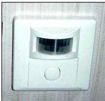
**Рис. 3.62.** Бытовой выключатель света — датчик движения LX-19B
