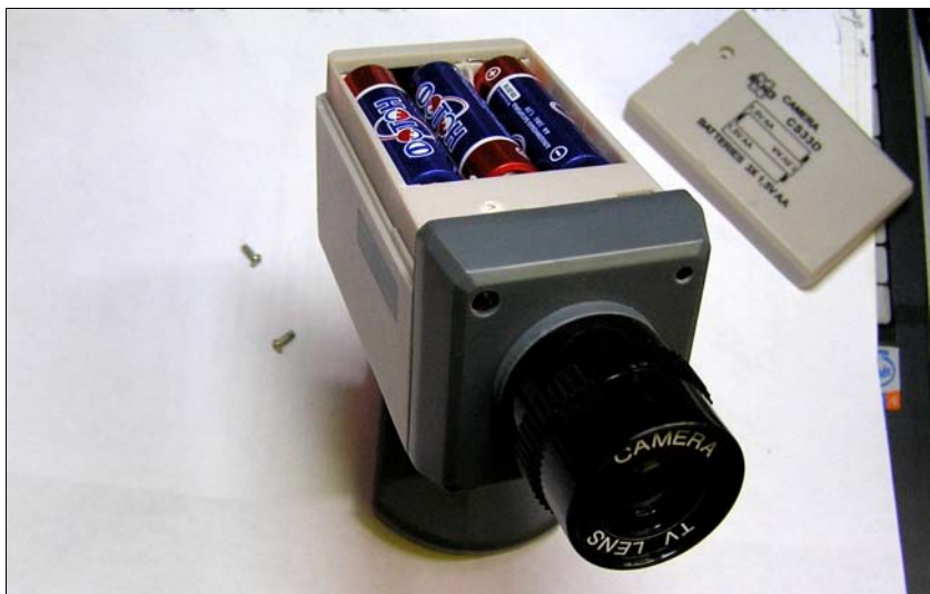
Рис. 1.17. Фальшкамера CS48DV — вид спереди и на батарейный отсек
