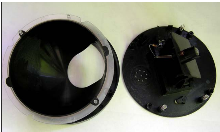
Рис. 1.12. Фальшкамера CS44D со снятой крышкой корпуса
