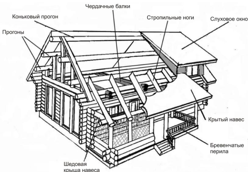
Рис. 6.2. Конструктивные элементы скатной крыши
