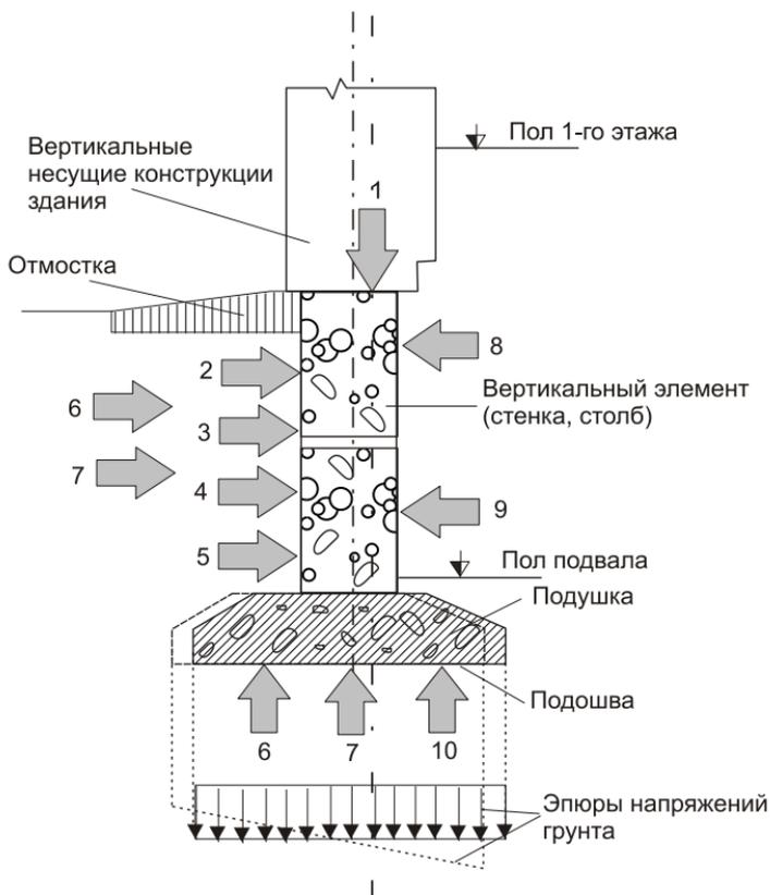
**Рис. 4.1.** Воздействия на фундаменты: 1 — нагрузка от здания; 2 — боковое давление грунта; 3 — сейсмические нагрузки; 4 — силы пучения грунта; 5 — упругий отпор грунта; 6 — вибрации; 7 — температура грунта; 8 — температура помещения подвала; 9 — влага воздуха подвала; 10 — влага грунта, агрессивные примеси в воде и воздухе, биологические факторы
