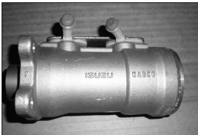
Рис. 3.10. Главный тормозной цилиндр
