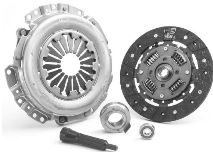
**Рис. 3.8.** Сцепление автомобиля в разобранном виде
