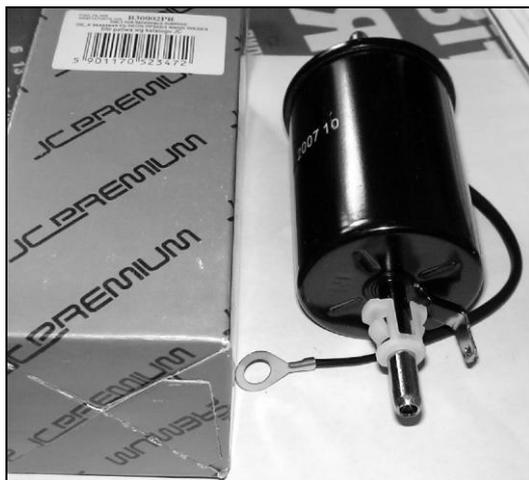
Рис. 2.9. Топливный фильтр
