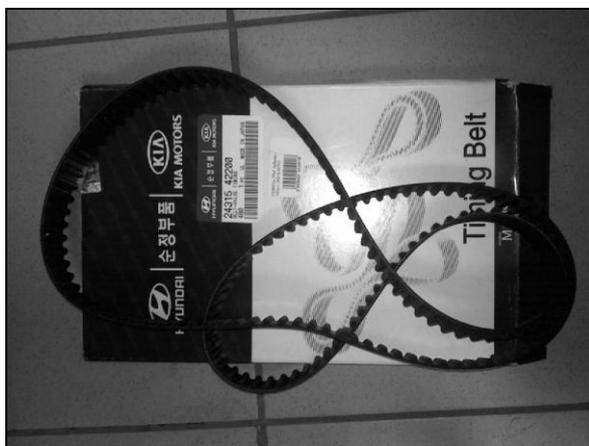
**Рис. 2.6.** Зубчатый ремень газораспределительного механизма
