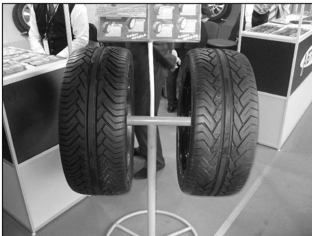
**Рис. 3.5.** Верхняя часть покрышки — протектор
