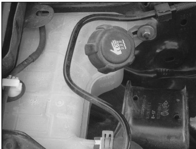
**Рис. 2.17.** Расширительный бачок системы охлаждения автомобиля «Рено»
