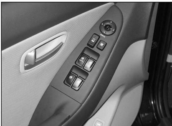
**Рис. 4.10.** Кнопки управления дополнительным оборудованием, размещенные на водительской двери
