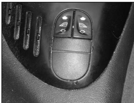
**Рис. 1.13.** Кнопки привода стеклоподъемника
