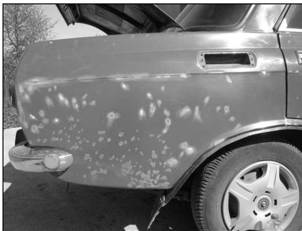
**Рис. 7.6.** Верхние пятна коррозии обработаны шкуркой, нижние — нет
