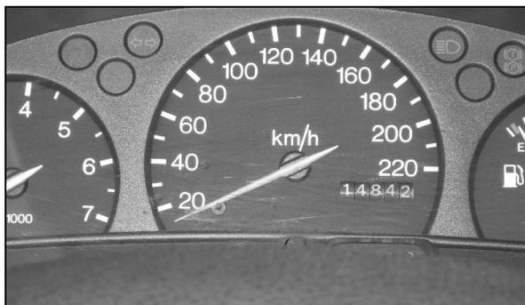
Рис. 4.9. Спидометр с одометром
