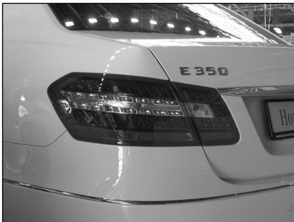
**Рис. 4.4.** Блок-фара задняя
