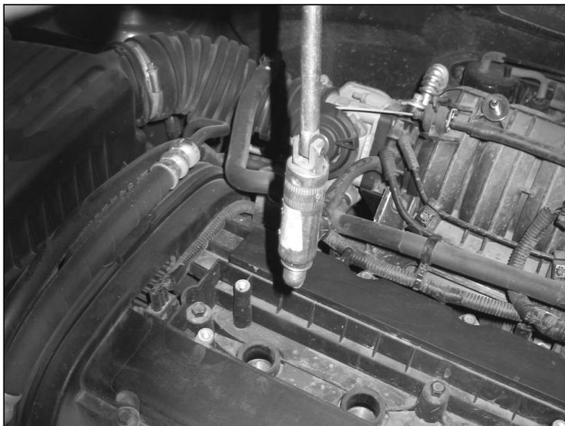
**Рис. 7.2.** Извлечение выкрученной свечи
