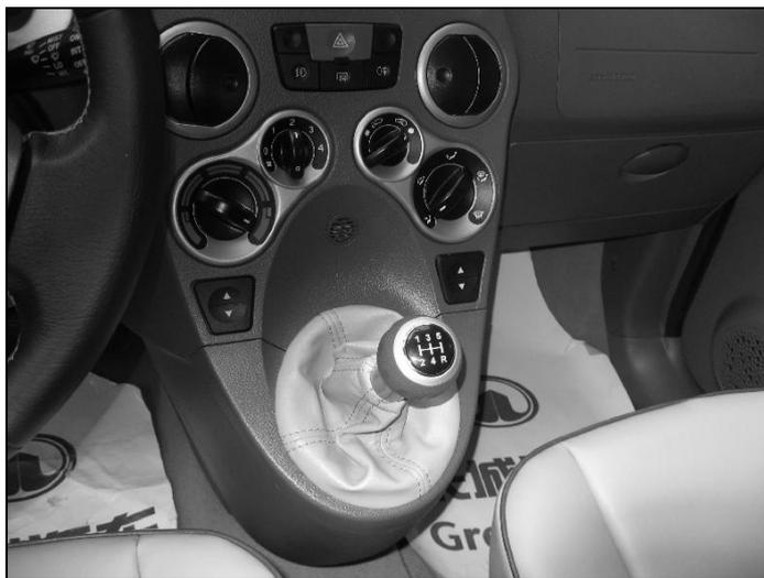
Рис. 3.6. Рычаг механической КПП
