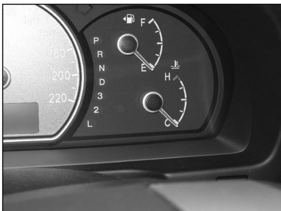
**Рис. 4.8.** Датчики уровня топлива и температуры охлаждающей жидкости
