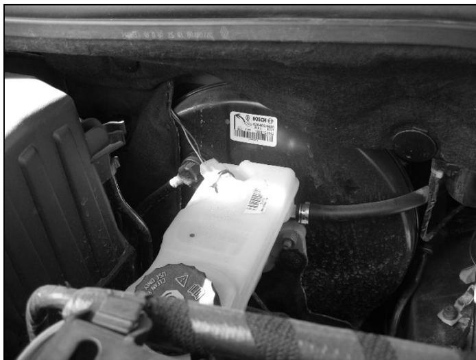
Рис. 3.11. За расширительным бачком — вакуумный усилитель тормозов
