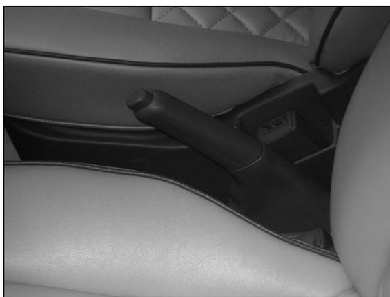
**Рис. 3.9.** Рычаг стояночного тормоза (ручник)
