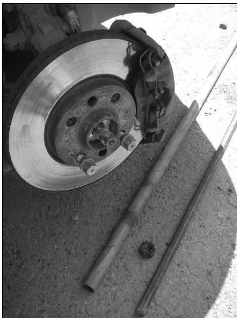
**Рис. 3.13.** Дисковый тормозной механизм
