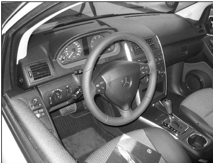
**Рис. 1.14.** Органы управления автомобилем
