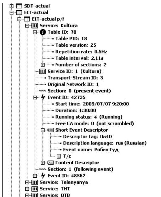
Рис. 5.17. Пример EIT, полученный при помощи программы StreamXpert (Dektec, Голландия)
