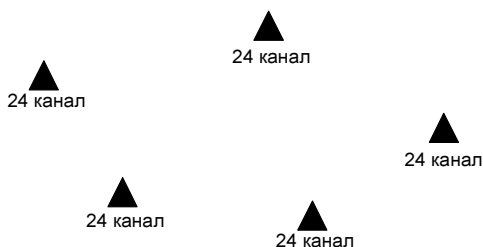
Рис. 8.14. Пример одночастотной сети
