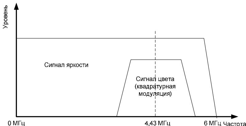
Рис. 1.5. Спектр композитного сигнала
