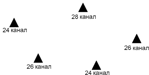
Рис. 8.15. Пример многочастотной сети
