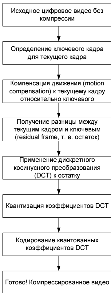
Рис. 3.6. Порядок операций при компрессировании видеоизображений
