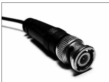
Рис. 1.7. Коннектор BNC (Источник: www.wikipedia.org )
