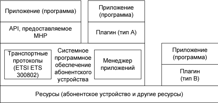
Рис. 9.12. Структура мультимедийной платформы для дома — MHP
