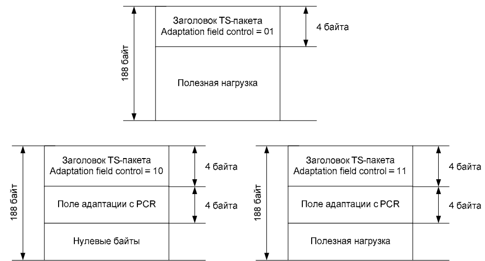
Рис. 5.6. Пакет транспортного потока с полем адаптации и без
