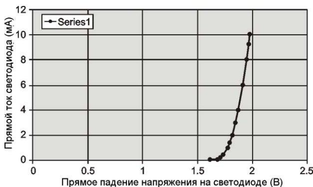
Рис. 2.3. Прямая ветвь вольт-амперной характеристики красного светодиода
