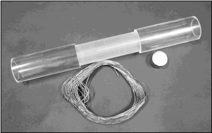
Рис. 7.4. Каркас из оргстекла, провод для намотки катушки и магнит
