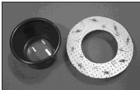
Рис. ПЗ.6. Монтаж резисторов
