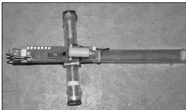
Рис. 7.31. Печатная плата игрушки, основанной на инерционности зрения
