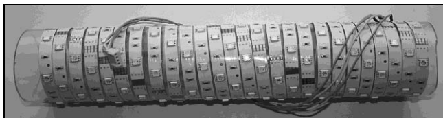
Рис. 3.23. Конструкция светодиодного излучателя
