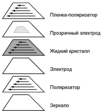
Рис. 4.3. Слои отражающего LCD в поляризованном состоянии кристаллов
