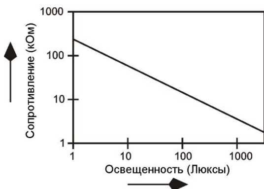
Рис. 5.4. Зависимость сопротивления фоторезистора от интенсивности света
