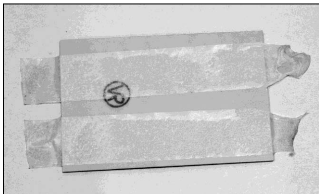
Рис. П2.11. Плата FR2 с двусторонней клейкой лентой
