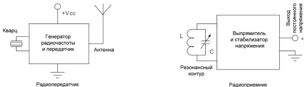
Рис. 1.23. Принцип питания от источника радиочастоты
