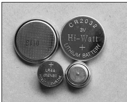
Рис. 1.17. Маленькая LR44 — щелочная батарея, большая CR2032 — литиевая батарея
