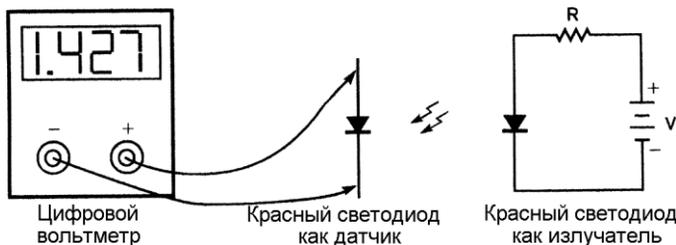
Рис. 7.54. Подключение светодиода в качестве фотодиода (источник: Dhananjay V. Gadre & Sheetal Vashist, ED senses and displays ambient-light intensity, EDN November 9, 2006)
